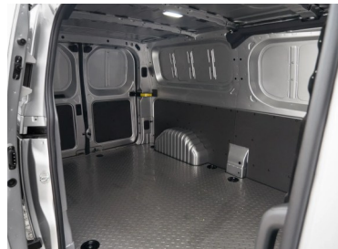
Aluminium-Riffelblechboden, halbhohe Seitenverkleidung und helle LED-Laderaumbeleuchtung
