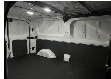
Halbhohe Laderaumverkleidung mit Befestigungspunkten für sichere Ladung und 2 LEDs
