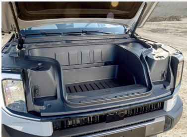
236 L Frunk für Werkzeug, Ladekabel & Co.- kombiniert mit V2L-Funktion
