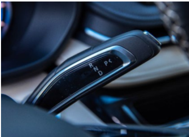
Schalthebel in Griffnähe – platzsparend und intuitiv bedienbar
