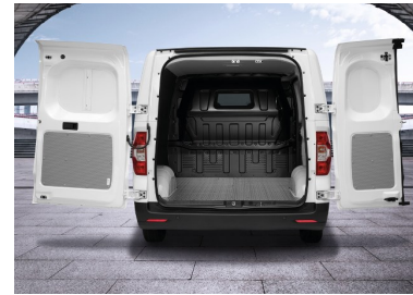
Heckflügeltüren mit 180° Öffnungswinkel und Parksensoren im hinteren Stossfänger
